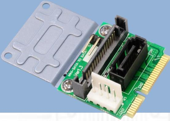
PMMD v1.1 は mSATA スロットに SATA コネクタを接続可能にする開発用治具です。SATA ポート・電源ケーブルを経由し、システム外部に SATA デバイスを接続することが可能です。
